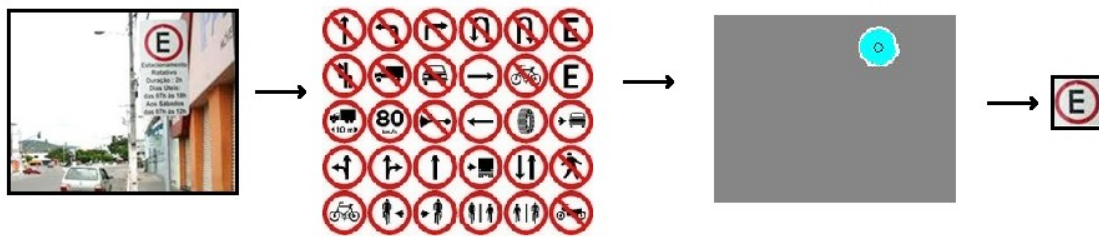
Figura 8. Exemplo de uso de Template Matching, retirado de [Ornellas; Komati, 2013].
