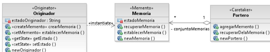
Figura 4. Diagrama de clases aplicando el patrón Memento.
